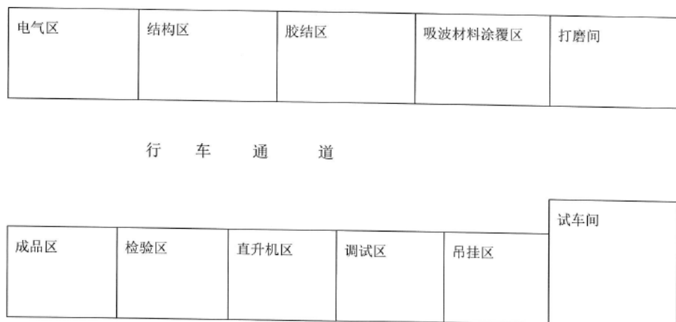
图 3-5 环评时生产车间平面布置图（1层）
